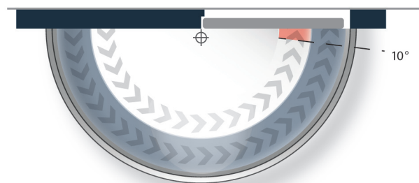
Diagramme de la force de fermeture Ferme porte FP1400 EN, côté paumelle
