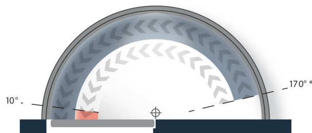
Diagramme de la force de fermeture Ferme porte FP1400 EN, côté opposé à la paumelle
