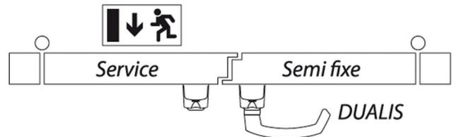
Crémone rotative réversible pour pose en applique avec vis de fixation cachées (sens de la main à choisir avant mise en place du capotage)
